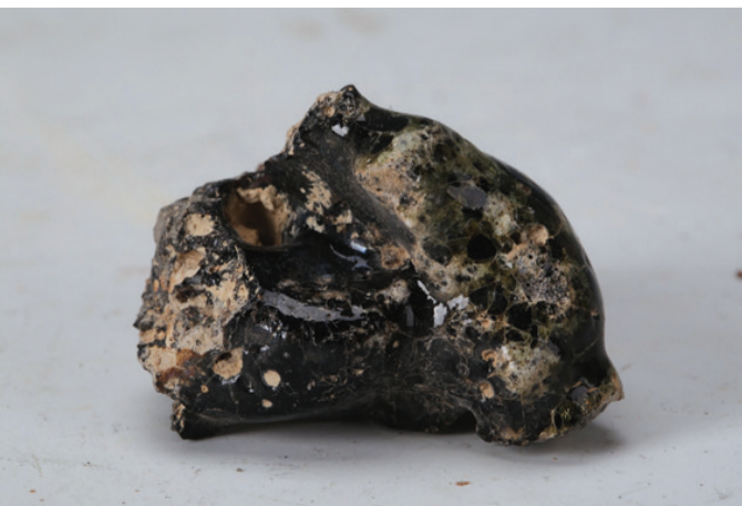
窑址中发现的玻璃状结晶物。这是由于在高温下烧窑时,窑内的草木灰所形成的“窑汗”。这种“窑汗”现象被烧窑的工匠们发现后,便发明了瓷器的“釉”。
