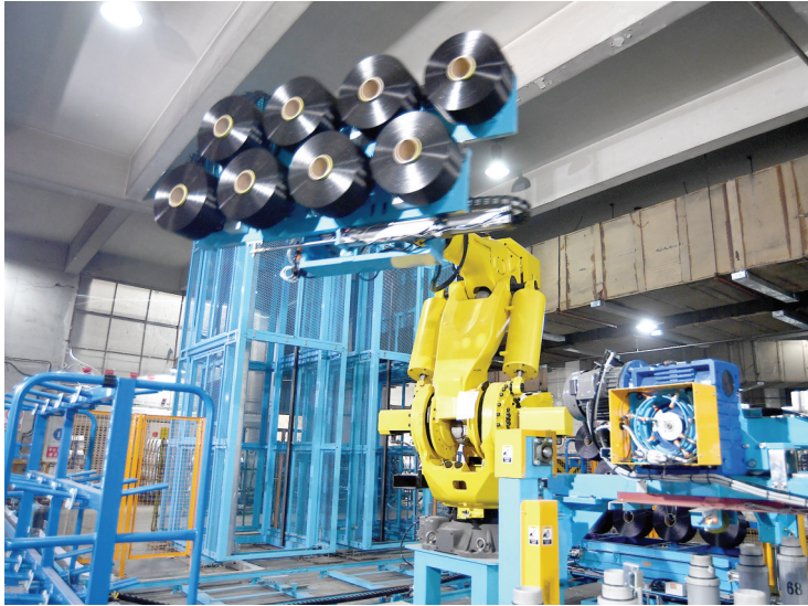
恒逸聚合物有限公司车间内的首条自动包装线,全部由数字化控制
