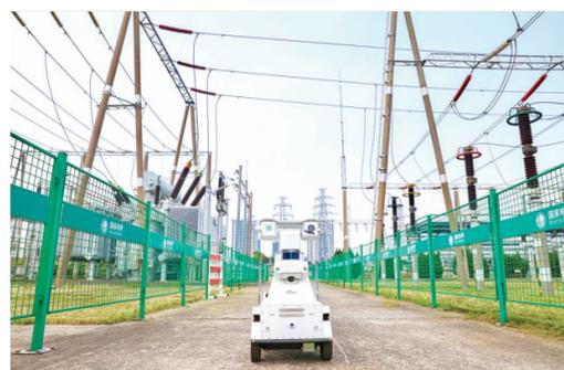
近日,在220千伏宁围变电站,国网杭州市萧山区供电公司员工利用变电站智能巡检机器人对电网设备进行实时监测,并将采集的数据通过无线网络传输给智能巡检管理系统。首席记者 唐柯 通讯员 应昊翰 沈书廷
