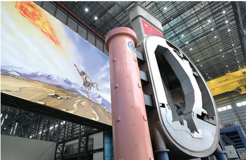
图为聚变堆主机关键系统综合研究设施八分之一真空室及总体安装系统主体平台
