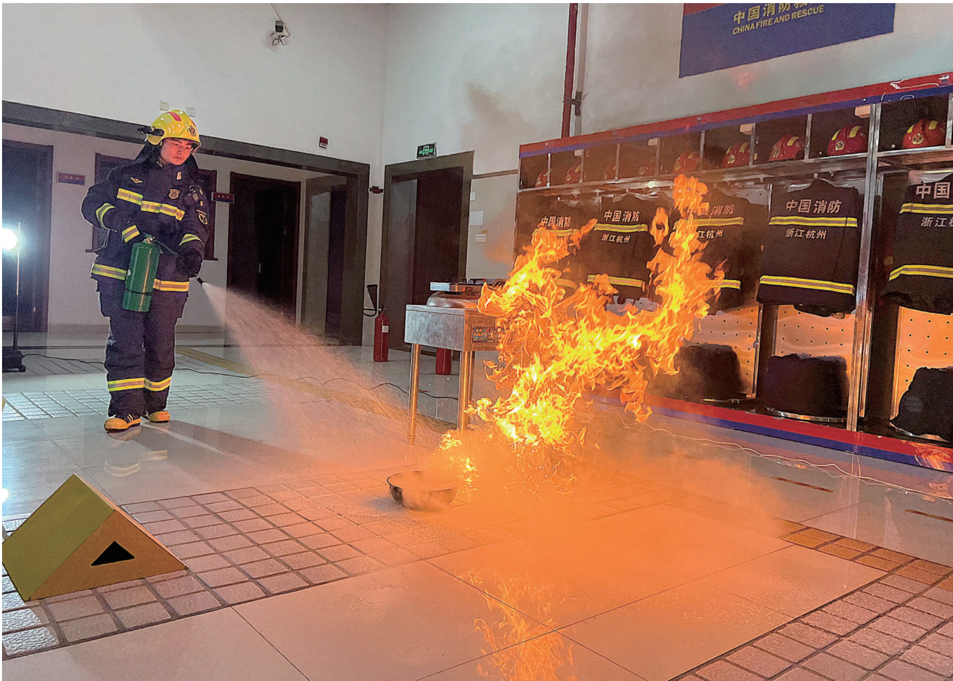
工作人员模拟油锅起火进行灭火实验
