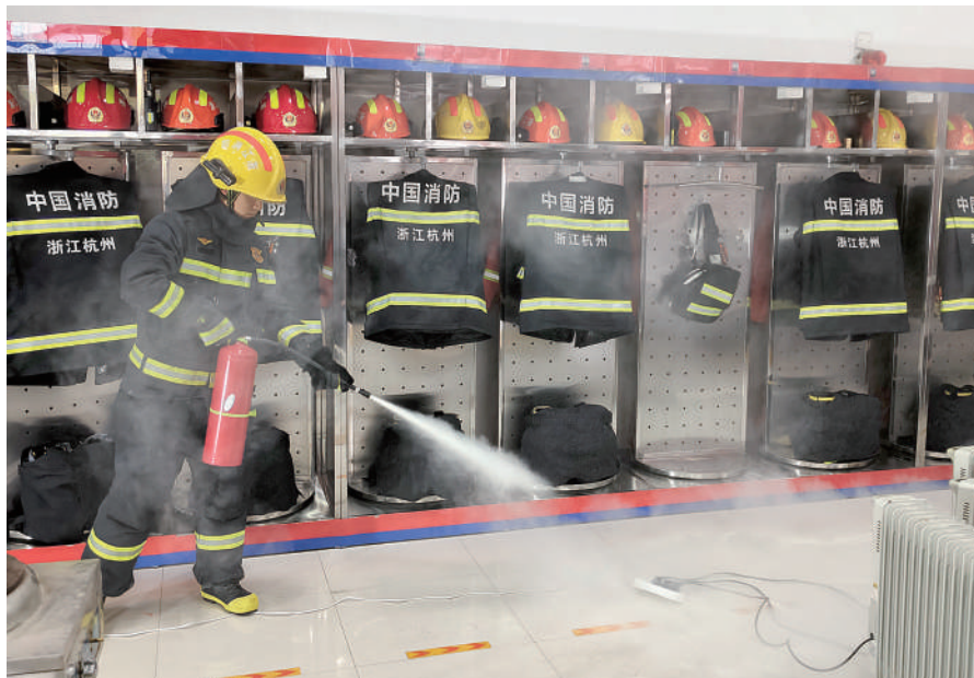
工作人员模拟插线板短路起火进行灭火实验
